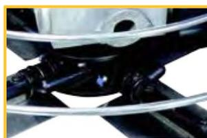
Os suportes das lâminas incluem um bocal de lubrificação para uma manutenção mais fácil.
