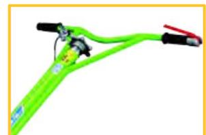
Passo das lâminas regulado por um botão ergonómico e uma transmissão de fio de aço.
