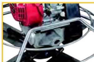
Caixa de velocidades em alumínio fundido, com rolamentos de forma cônica.
